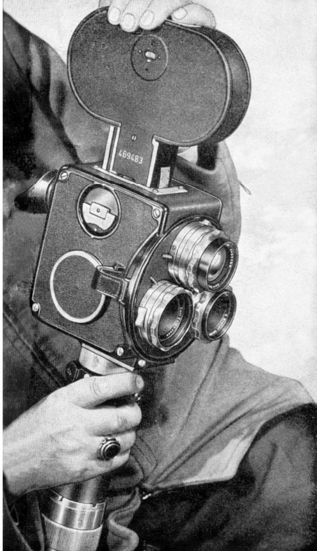
Abb. 2 Einsetzen der Kassette
